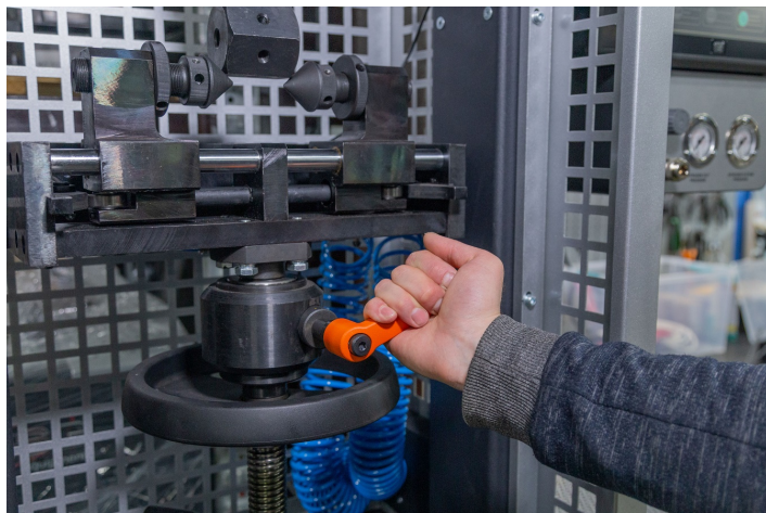
Rysunek 22. Poluzowanie ogranicznika dolnego zacisku
