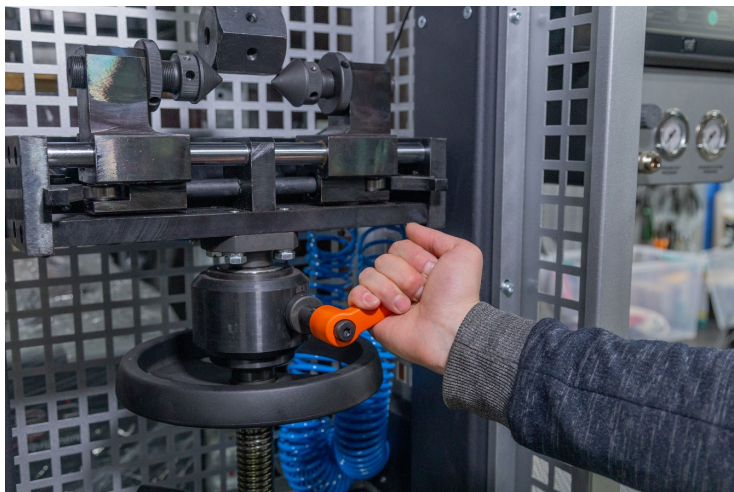
Рисунок 22. Ослабление стопора нижнего зажима
