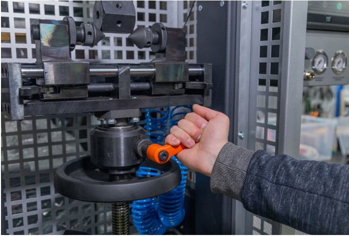
Figura 22. Aflojamiento del bloqueador de la mordaza inferior.
