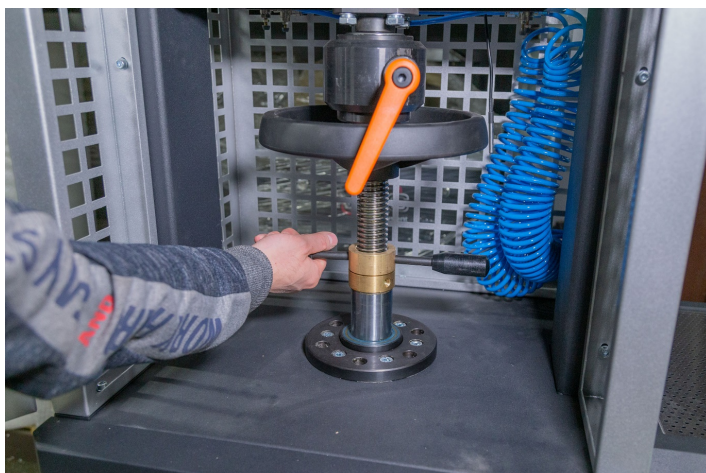
Rysunek 23. Poluzowanie ogranicznika regulacji wysokości dolnego zacisku
