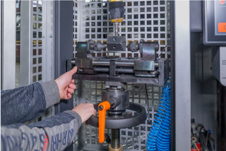
Rysunek 24. Regulacja wysokości dolnego zacisku pneumatycznego
