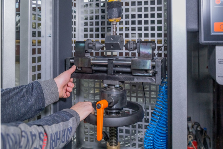
Рисунок 24. Регулювання висоти нижнього пневматичного затискача.
