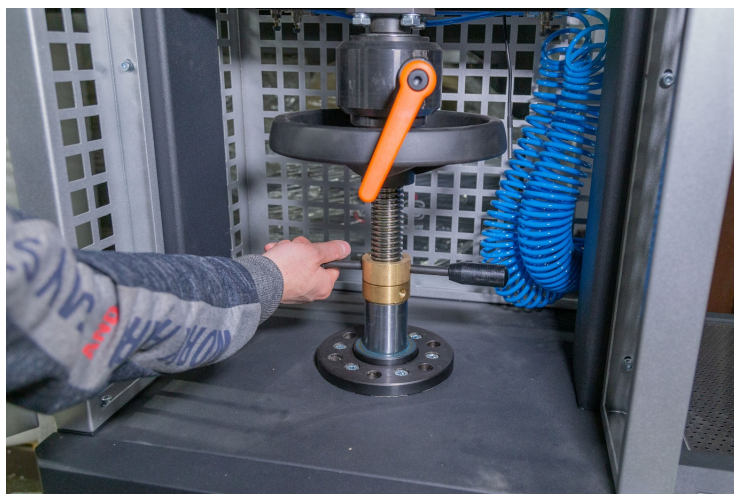
Рисунок 23. Ослаблення стопора регулювання висоти висоти нижнього затискача.
