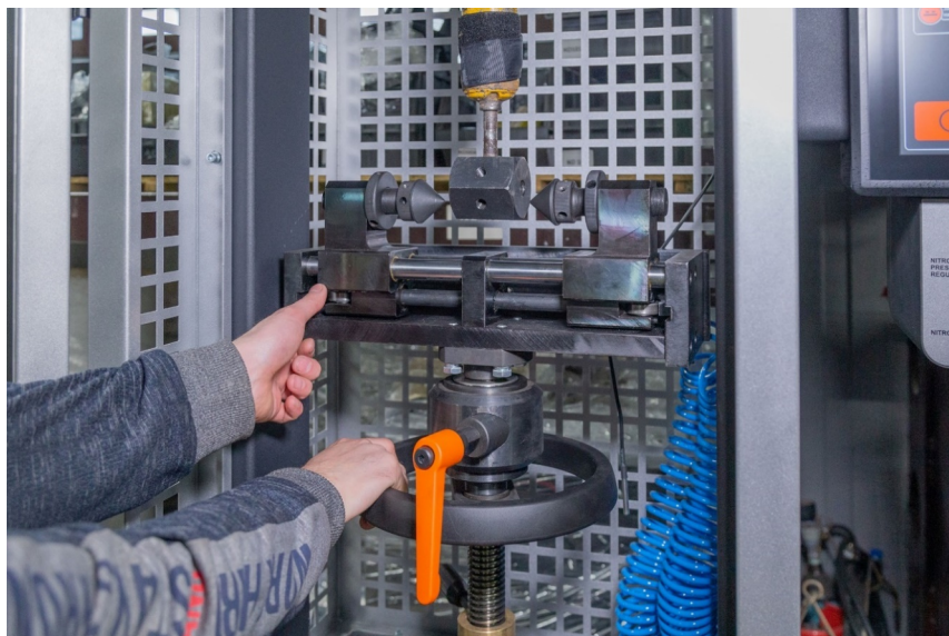
Figura 24. Ajuste de la altura de la mordaza neumática inferior.
