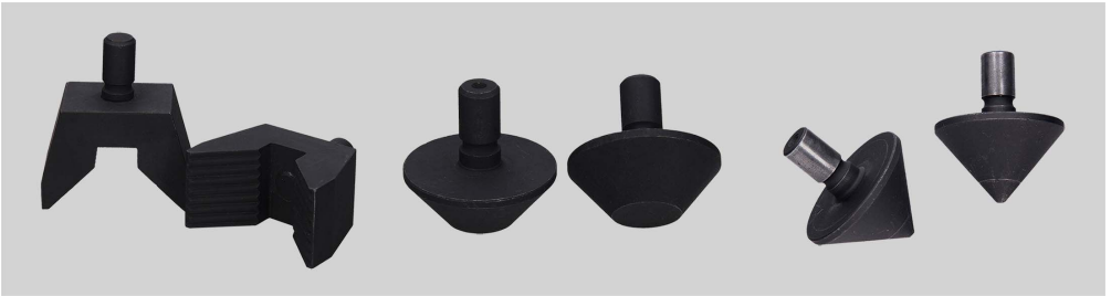
Рисунок 2. Змінні кріплення для нижнього пневматичного затискача під різні типи кріплень амортизаторів
