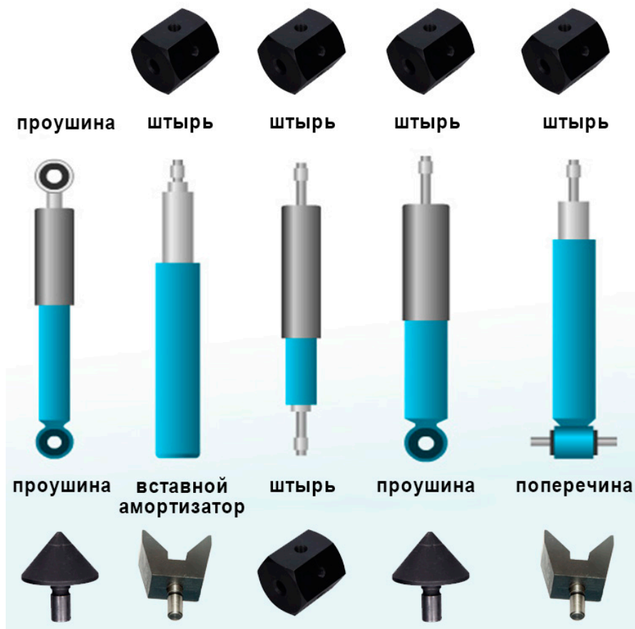
Рисунок 16. Типы креплений амортизаторов и сочетание приспособлений для их монтажа на стенде
