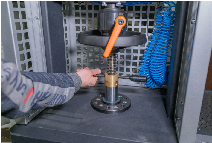
Figura 23. Aflojamiento del bloqueador de ajuste de altura de la mordaza inferior.
